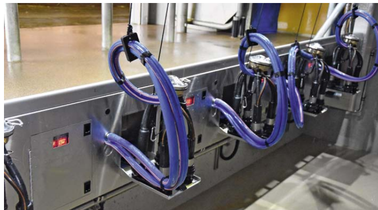
Partie technique bien protégée pour une longue durée de vie. Les compteurs de lait et les pulsateurs sont intégrés dans le coffret.
