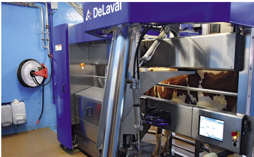
La meilleure hygiène possible avec le système de traite VMS: le gobelet laveur et les gobelets trayeurs sont lavés à l'intérieur et à l'extérieur après chaque vache et restent ainsi parfaitement propres.
