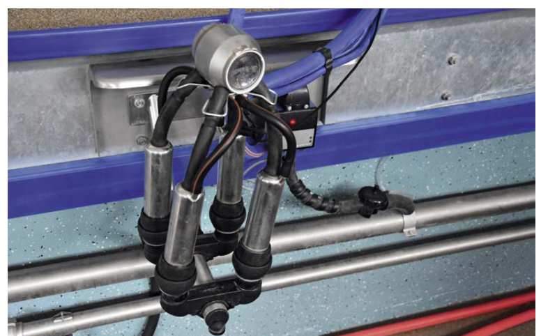
Confort de la vache et du trayeur: le robuste faisceau trayeur MC73 en acier inoxydable, équipé de la technologie innovante Top Flow, permet un débit rapide et sans perturbation du lait depuis la griffe.
