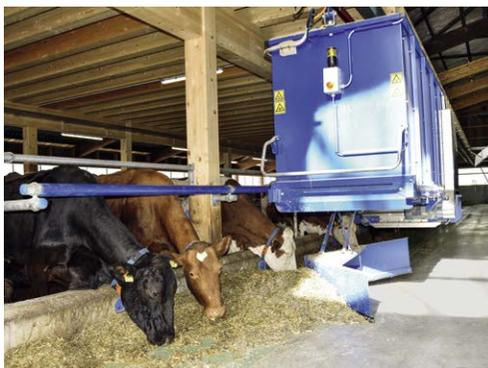
Distribution et repoussement. Toutes les deux heures, le robot d'affouragement distribue du fourrage frais et le repousse vers les vaches.
