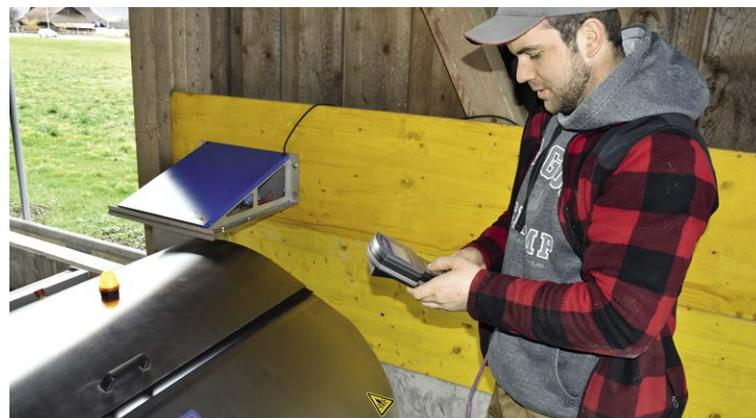
Adrian Annen avec l'OptiDuo. Très ergonomique, l'unité de commande permet de piloter le robot manuellement. En exploitation automatique régulière, elle peut être rangée – et ainsi bien protégée – dans l'OptiDuo.
