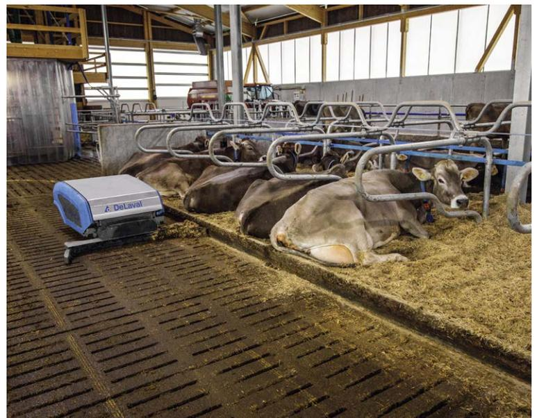
Le robot racleur RS450 se charge de nettoyer les surfaces dans l'étable. Les vaches de la famille Oswald ont ainsi des onglons en meilleure santé et sont plus propres.
