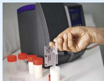
1. Avec la carte d'analyse, prélever un échantillon de lait (en appuyant sur le piston, du lait est aspiré)
