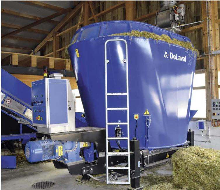
Mélangeuse fixe verticale de 12 m<sup>3</sup> avec variateur continu de 30kW, commande et ordinateur de pesage. À droite sur l'image, l'armoire de commande des fraises pour désilage.
