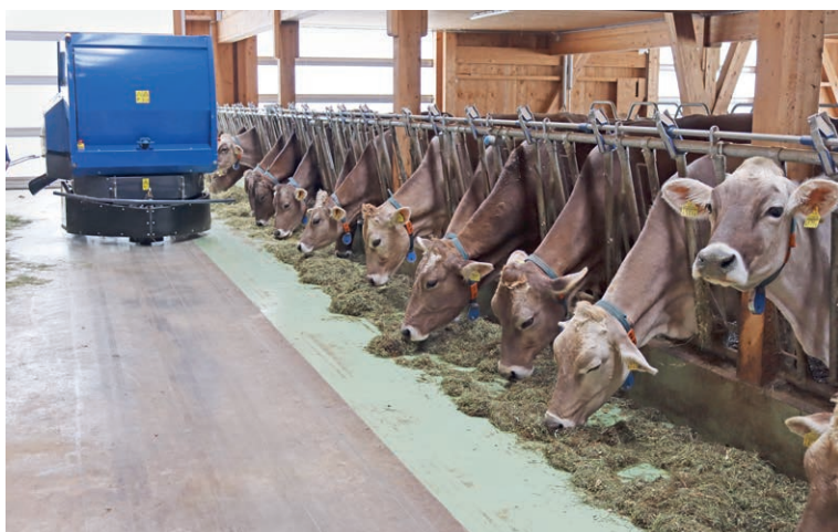
L'OptiWagon est équipé d'une lame frontale. Les batteries sont rechargées à la station de charge. La distribution précise fonctionne grâce au fond mouvant, aux rouleaux de dosage et à la bande transporteuse transversale.
