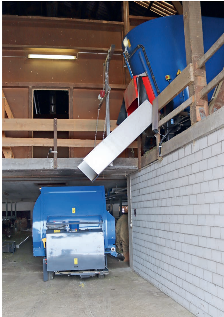
La mélangeuse fixe Optimat se trouve à l'étage supérieur, ce qui permet de gagner de la place. Elle y est remplie, prépare le mélange et le déverse via une goulotte dans le chariot d'affouragement OptiWagon.
