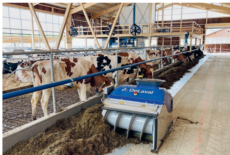
L'OptiDuo repousse les aliments tout en les détassant.
